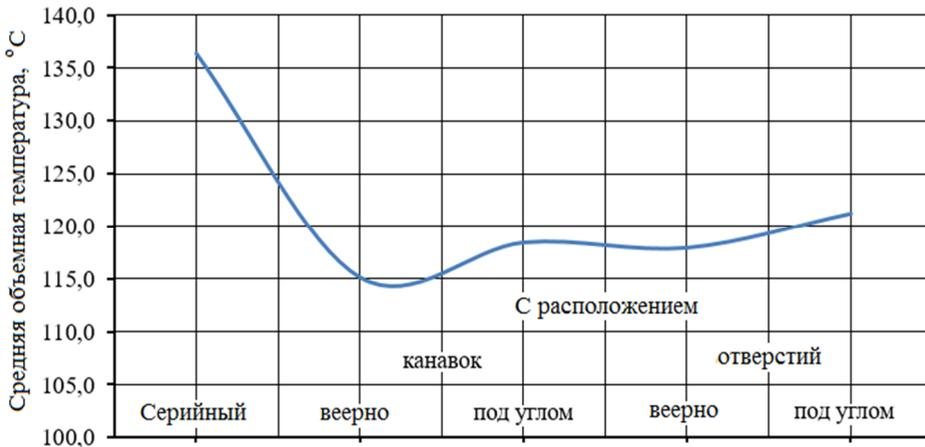
Рис. 8. Значения средней объемной температуры серийных и усовершенствованных с элементами охлаждения самовентилируемых дисков тормоза грузового транспортного средства модели «MAN»
